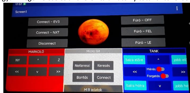
4. ábra: A mobiltelefonos applikáció egyik változata a rover irányítására, markoló mozgatására, fúró kezelésére, szenzorok adatgyűjtésére, roveren lévő vezérlőkhöz kapcsolódáshoz
