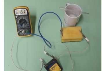
5. ábra: Áramerősség-mérés a szivacsmodellen 4,5 V elemmel és vízcseppentővel
