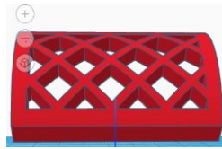
9. ábra: 1. Minta, ötlet (cellás csűrője); 2. CAD-tervezés; 3. 3D-nyomtatás; 4. Egy szárnyas CanSat 1:1 makettje
