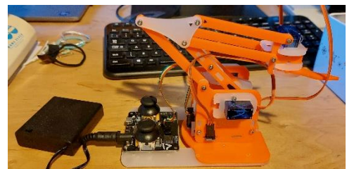
7. ábra: Távvezérelhető, diákok által összeszerelt robotkar és vezérlője
