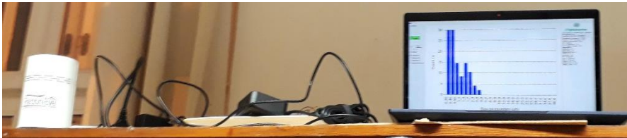
6. ábra: Gázszenzorok, méretfrakció-mérő és radonmérő együttes működése
