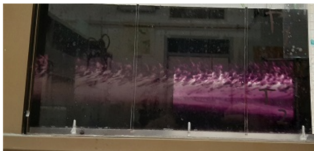
19. ábra. A kád végén feláramlás történt, és egy eddig nem látott, középmagasságú, bal irányba haladó áramlás jelent meg.
