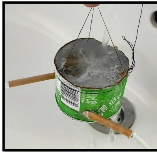
9. ábra: A Segner-kerék modellezése konzervdobozzal
