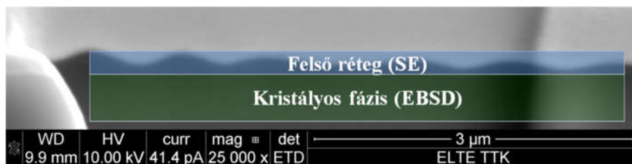
3. ábra. A 2. ábrán látható LIPSS keresztmetszete.
